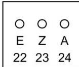
Der Anschluss für die Lüftertaster liefert an der Anschlussklemme „E“ ein Pluspotential (nur im Netzbetrieb). Das Schalten des Potentials auf die Anschlussklemmen „Z“ oder „A“ bewirkt eine „ZU“ oder „AUF“-Funktion der angeschlossenen Öffnungsaggregate. Werden beide Anschlussklemmen mit „E“ verbunden, stoppen die Motore.
