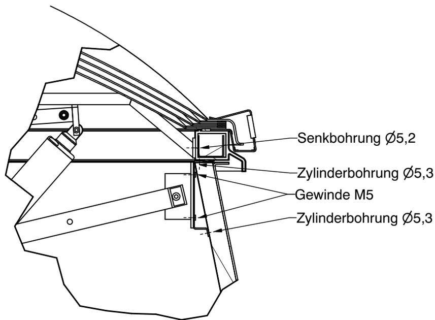
Montage an Gebäudeöffnungen (z.B. "ISBA" - Lichtkuppel mit Aufsatzkranz 300 mm)
